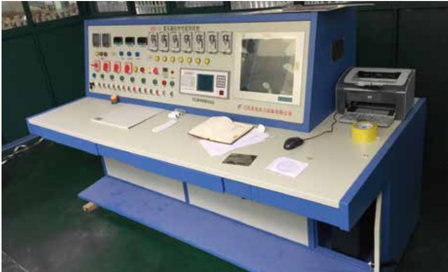
电力变压器综合实验平台
